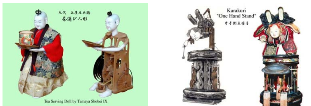
Bild 1: Karakuri-Figuren liegen komplexe, Uhrwerken ähnliche Mechanismen aus Nocken und Hebeln zugrund
