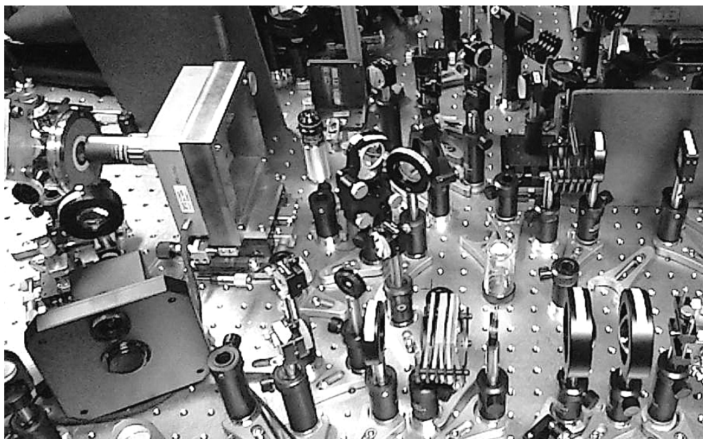
Grafik 2: Messanordnung für optische Untersuchungen an einzelnen Quantenpunkten
