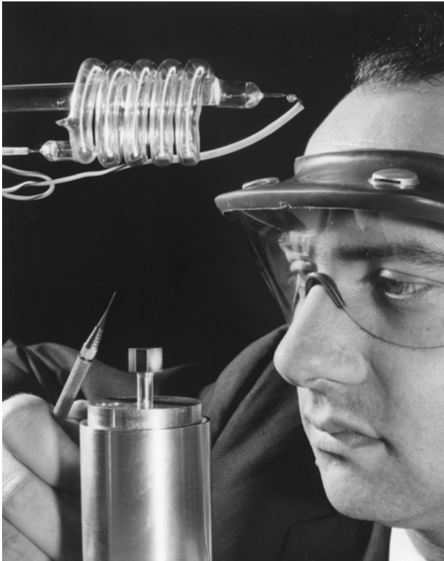
Abbildung 1 Theodore Maiman und der erste Laser. Der Würfel ist der Rubinkristall, der als aktives Medium diente. Das spiralförmig aufgewickelte Rohr ist eine Gasentladungslampe, die dem optischen Pumpprozess dient. (Hughes Aircraft Company)
